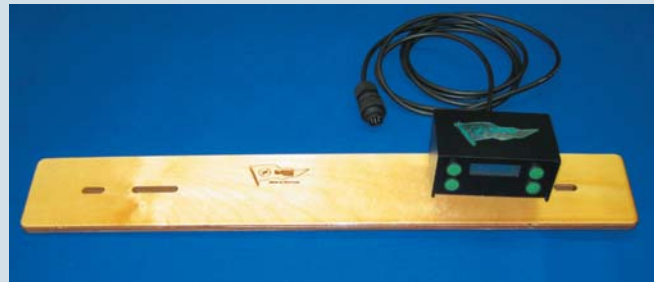
Digitale Anzeige- und Steuereinheit montiert auf Traveller Digital indicator and control unit, mounted on traveller
